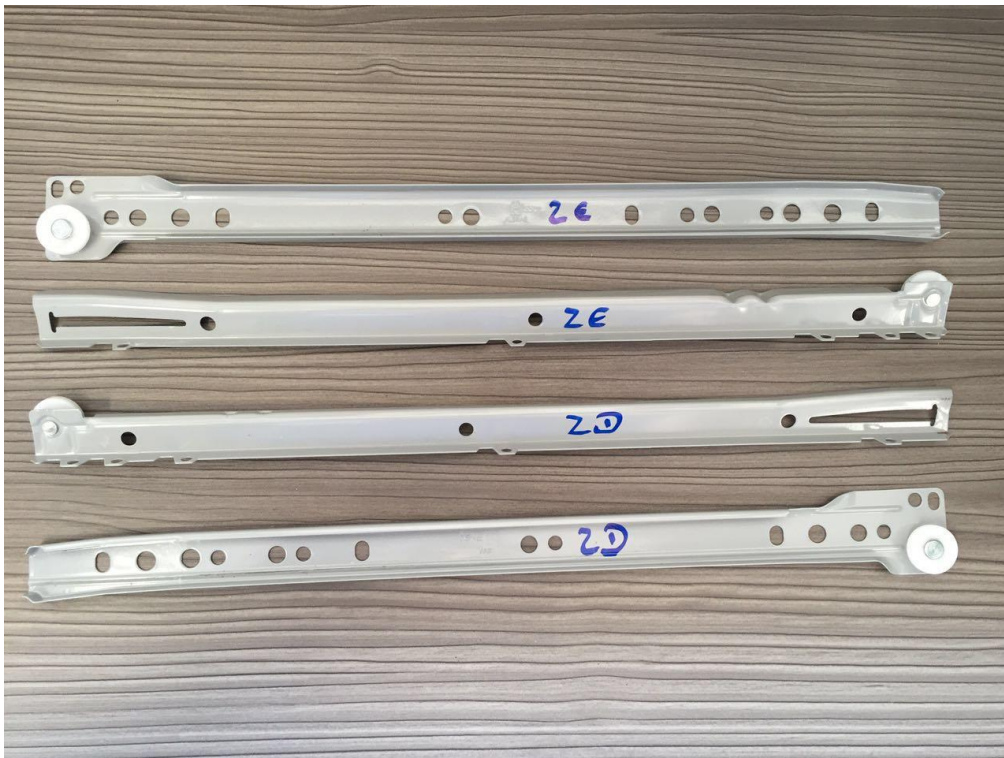
Figura 2 – Corrediça após os 80.000 ciclos
