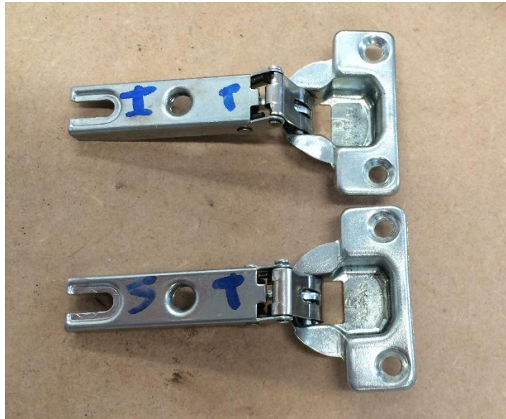
Figura 2 – Detalhe das dobradiças após o ensaio
