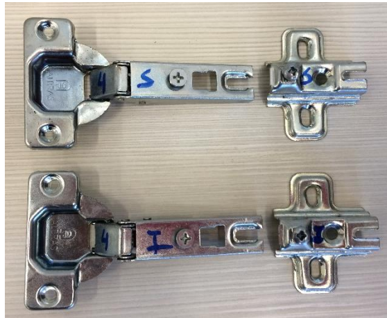
Figura 2 – Detalhe das dobradiças após o ensaio
